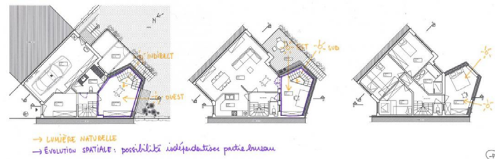
En prévoyant un accès et une circulation interne séparés lors d'une extension du logement « Clos Dupont », celle-ci peut également être utilisée séparément de l'habitation, par exemple pour une profession libérale, un kot d'étudiant ou une maison intergénérationnelle. ©VLA-Architecture
