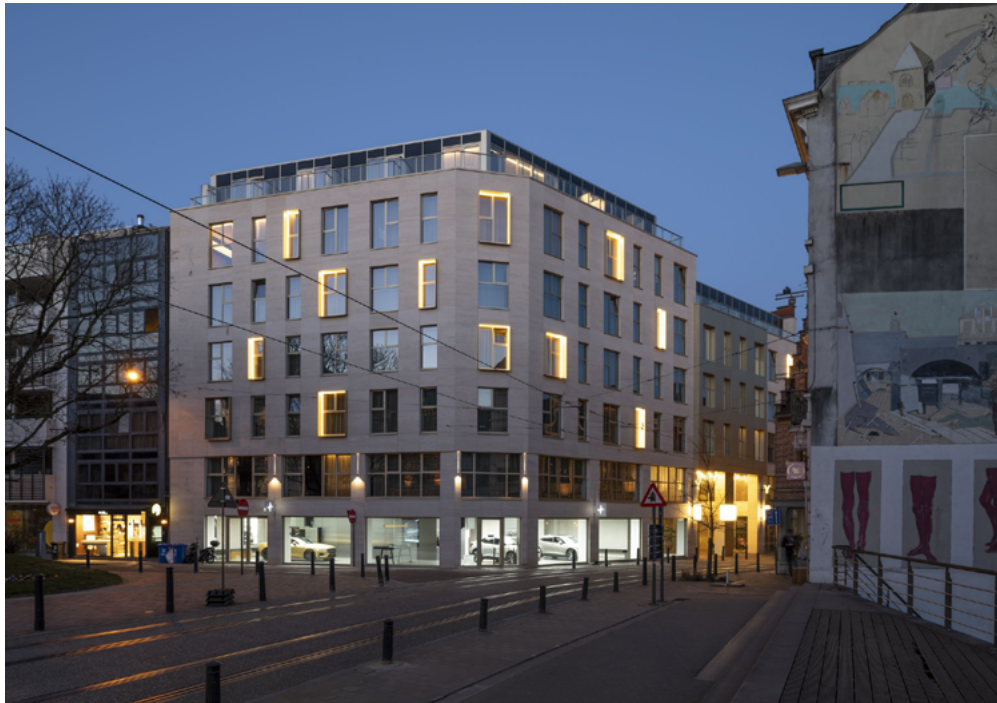
Lors de la réaffectation, la structure en colonnes d'un centre commercial a déterminé la taille de la distribution des pièces et le rythme des ouvertures de façade de l'hôtel Yalo. © Bontinck
